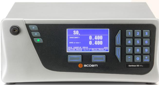
**L'analyseur de dioxyde de soufre (SO<sub>2</sub>) Serinus 50 affiche des performances précises et fiables pour un excellent rapport qualité-prix. Il utilise une technologie éprouvée de rayonnement fluorescent UV pulsé pour mesurer le SO<sub>2</sub> dans l'air ambiant pour mesurer le SO<sub>2</sub> dans l'air ambiant (limite de détection : < 0.3 ppb, sur la gamme 0-20 ppm)**
