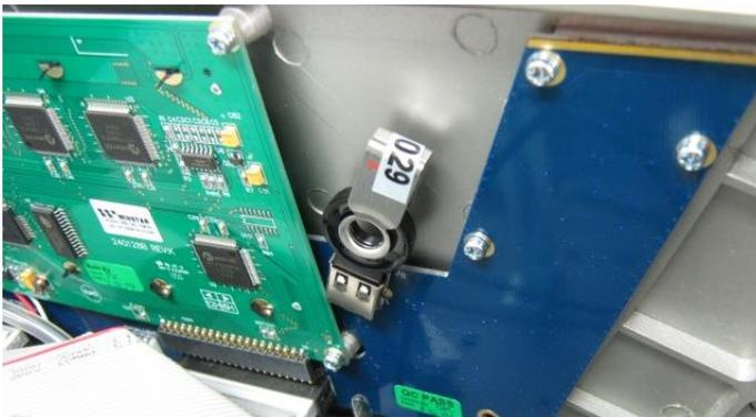
**Figure 8 – Installation de la clé USB**
