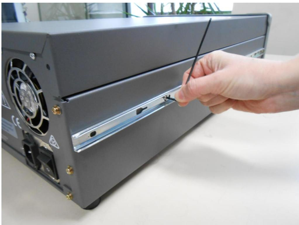
**Figure 71 – Assemblage de la glissière interne sur le châssis**
