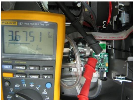
**Figure 62 – Mesure typique du point de test du capteur de pression de la cellule**
