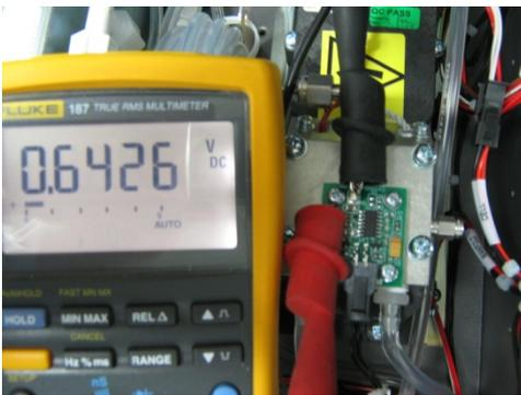
Figure 59 – Mesure typique du point de test de la pression de la cellule avec la pompe à vide reliée au port Exhaust (Échappement)
