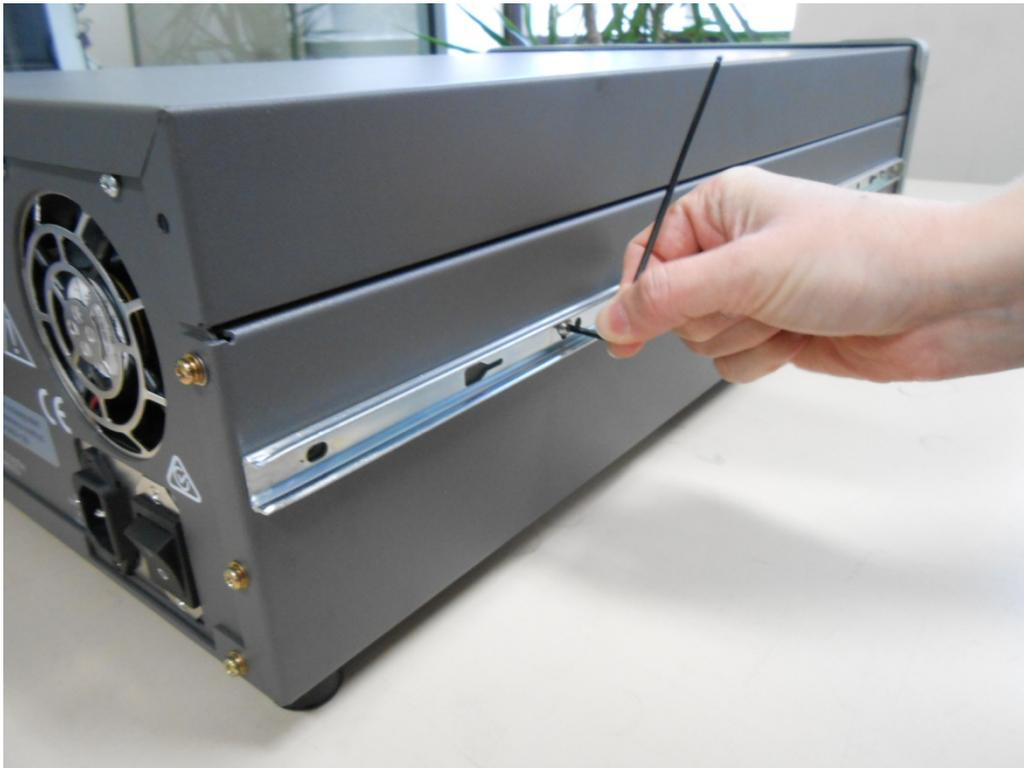
**Figure 72 – Assemblage de la glissière interne sur le châssis**
