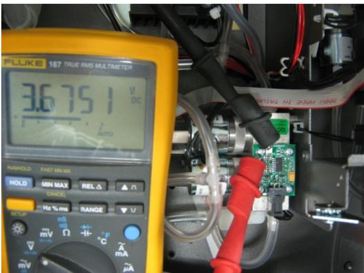
Figure 60 – Mesure typique du point de test du capteur de pression du collecteur
