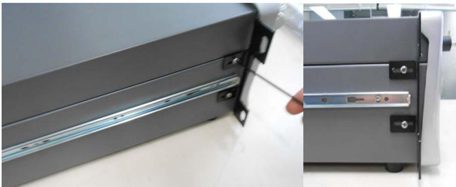
**Figure 73 – Oreilles de montage du rack fixées sur l'instrument**
