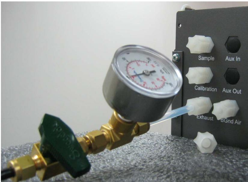
Figure 56 – Équipement de contrôle de l'étanchéité relié au port Exhaust (Échappement)
