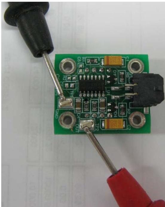
**Figure 58 – Emplacement des points de test**
