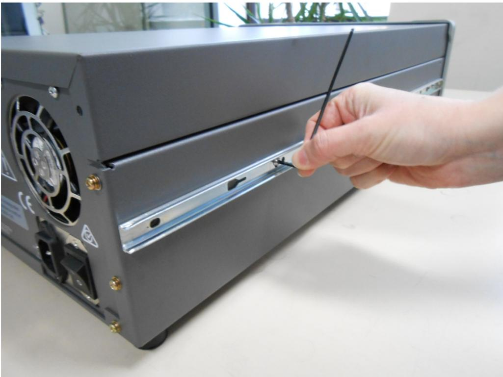
**Figure 67 – Assemblage de la glissière interne sur le châssis**
