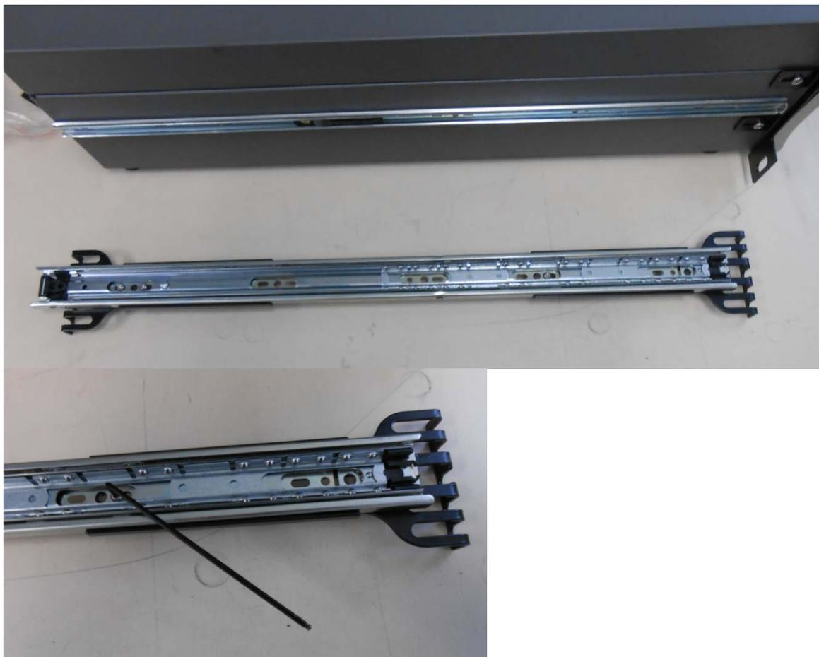
**Figure 69 – Fixation des adaptateurs de montage sur rack aux glissières externes**
