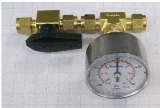
Figure 51 – Équipement de test d’étanchéité – (Réf. : H050069)
