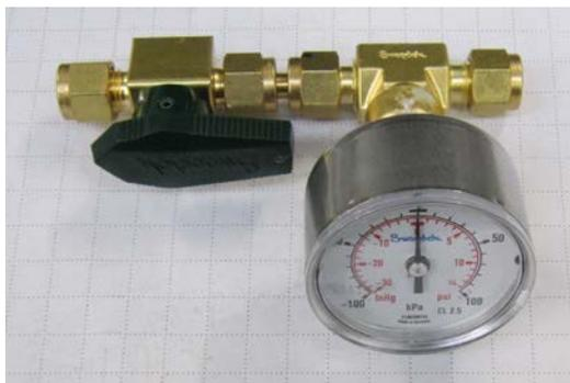
Figure 51 – Équipement de test d’étanchéité – (H050069)
