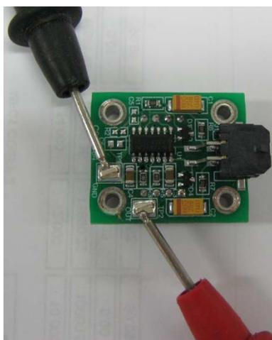
Figure 63 – Emplacement des points de test
